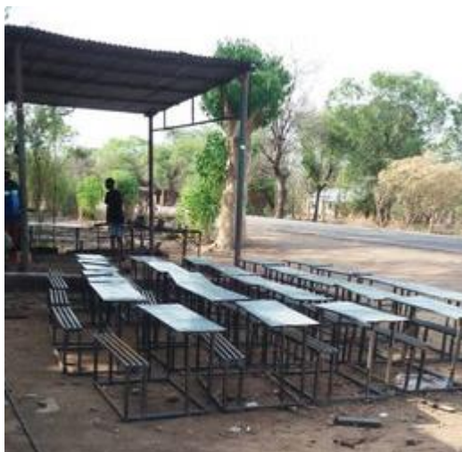
Termitensichere Doppelpulte aus Metall, fabriziert in einer Metallwerkstatt vor Ort
